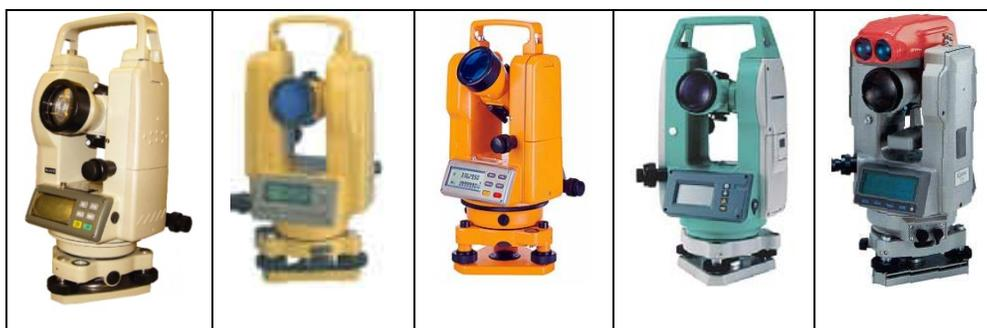
Un Teodolito–EDM integrado se llama **Estación Total**, o estación integrada, ya que permite obtener singularmente todas las mediciones del levantamiento topográfico como los ángulos, distancias, coordenadas, etc. Los datos pueden ser registrados en un dispositivo de memoria, denominado habitualmente “libreta electrónica”, con lo que se evitan los posibles errores de transcripción y se aceleran las operaciones de medición.
