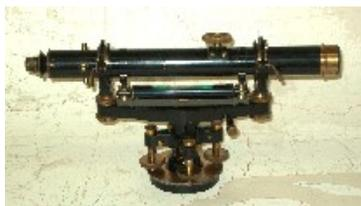
El Nivel Topográfico es un instrumento óptico-mecánico cuya misión principal es la de materializar un plano perfectamente horizontal.
